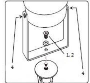
1. Pour fixer le piquet au projecteur à DEL, vous devez d'abord retirer la vis à tête hexagonale et la rondelle du piquet à l'aide de la clé Allen fournie (figure 1).
