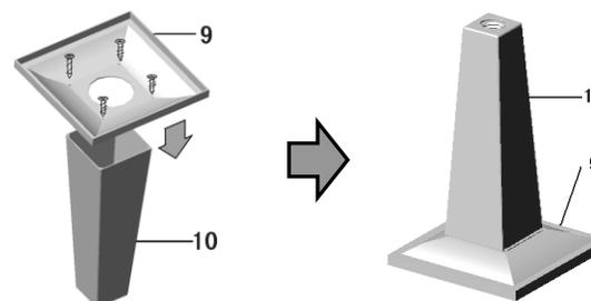
B. Assembler les 4 pièces de l'habillage du socle (7) ensemble, puis avec les piquets les fixer au socle (9).
